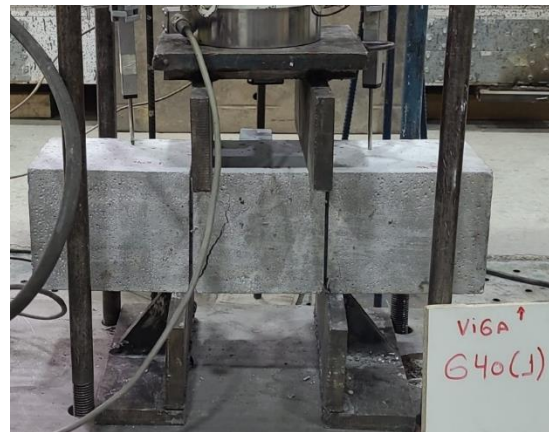
Figura 9. Agrietamiento fuera del plano de corte.
