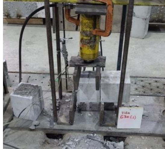
Figura 8. Modo de falla en el ensayo de corte directo
