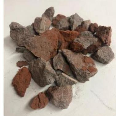
*Fig. 1. Tipos de áridos reciclados según el material de origen.*
