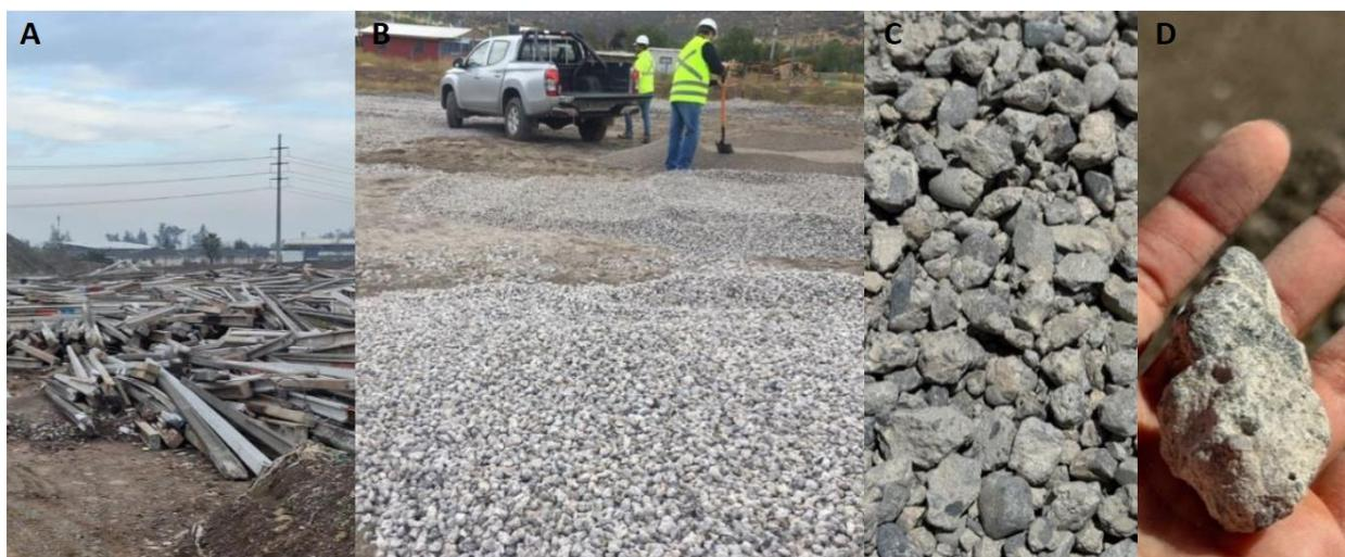
Fig. 4. Proceso de caracterización árido proveniente de postes de electricidad.
