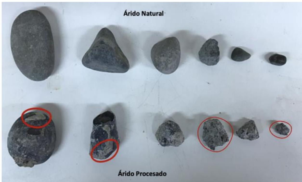
Fig. 2. Comparación visual de un árido natural y un árido procesado de escombros de hormigón.
